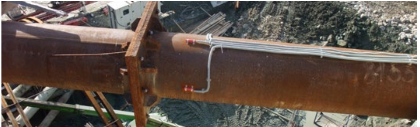
Jauges de déformation soudées par points sur un buton
